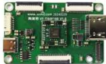
VF-Ti60F100 易灵思 超小 低功耗60K模块
